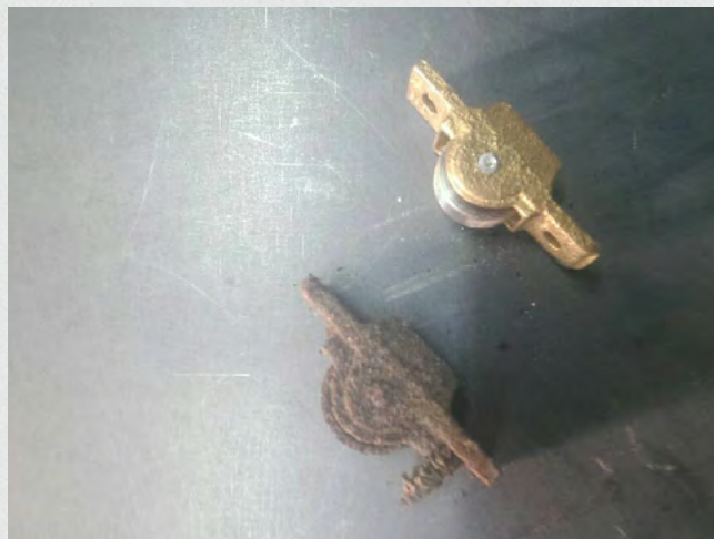
老舊金屬零件取得不易，除鏽後能再次使用。
