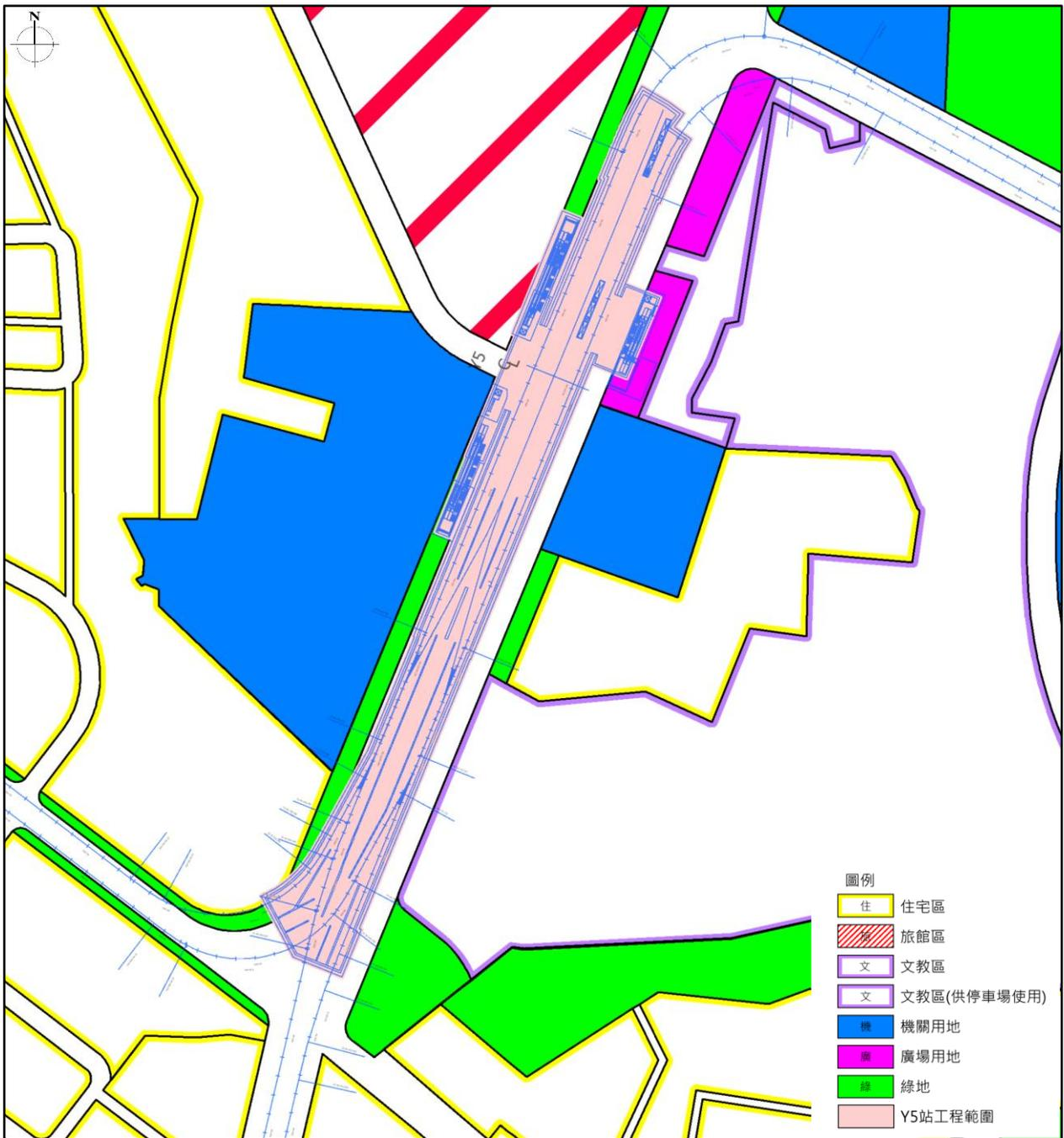
圖 4-5-3 捷運黃線 Y5 站工程範圍示意圖
