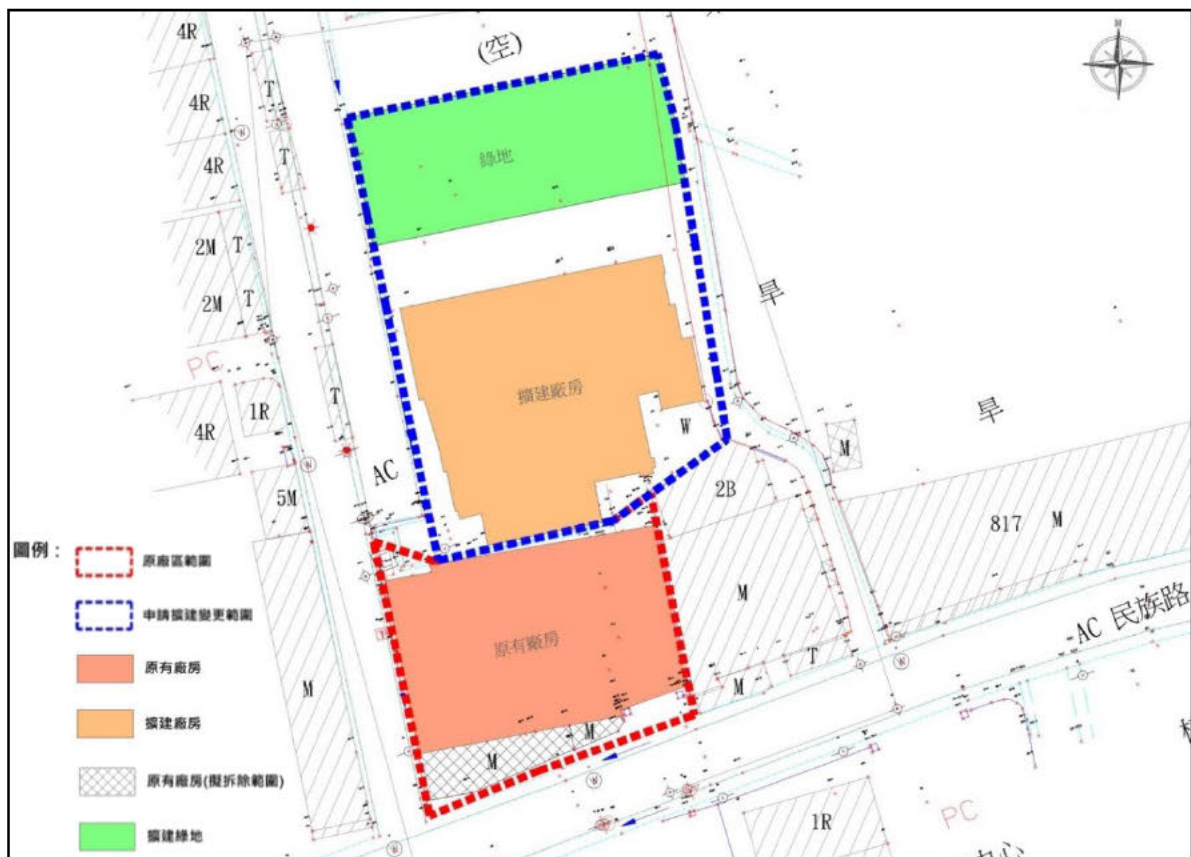
圖 7-1 原廠建築預計拆除範圍示意圖
