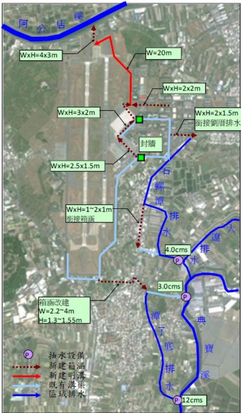
圖1 石螺潭排水與潭子底排水調適改善工程佈置示意圖
