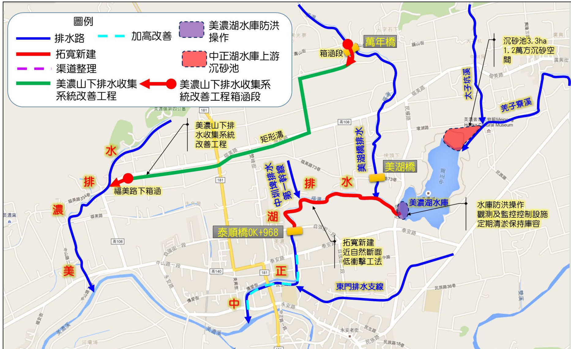
圖2 美濃湖排水綜合治水措施示意圖
