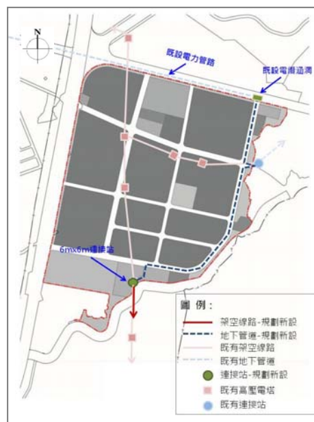
圖 5-2-10 架空輸電線路地下化規劃示意圖
