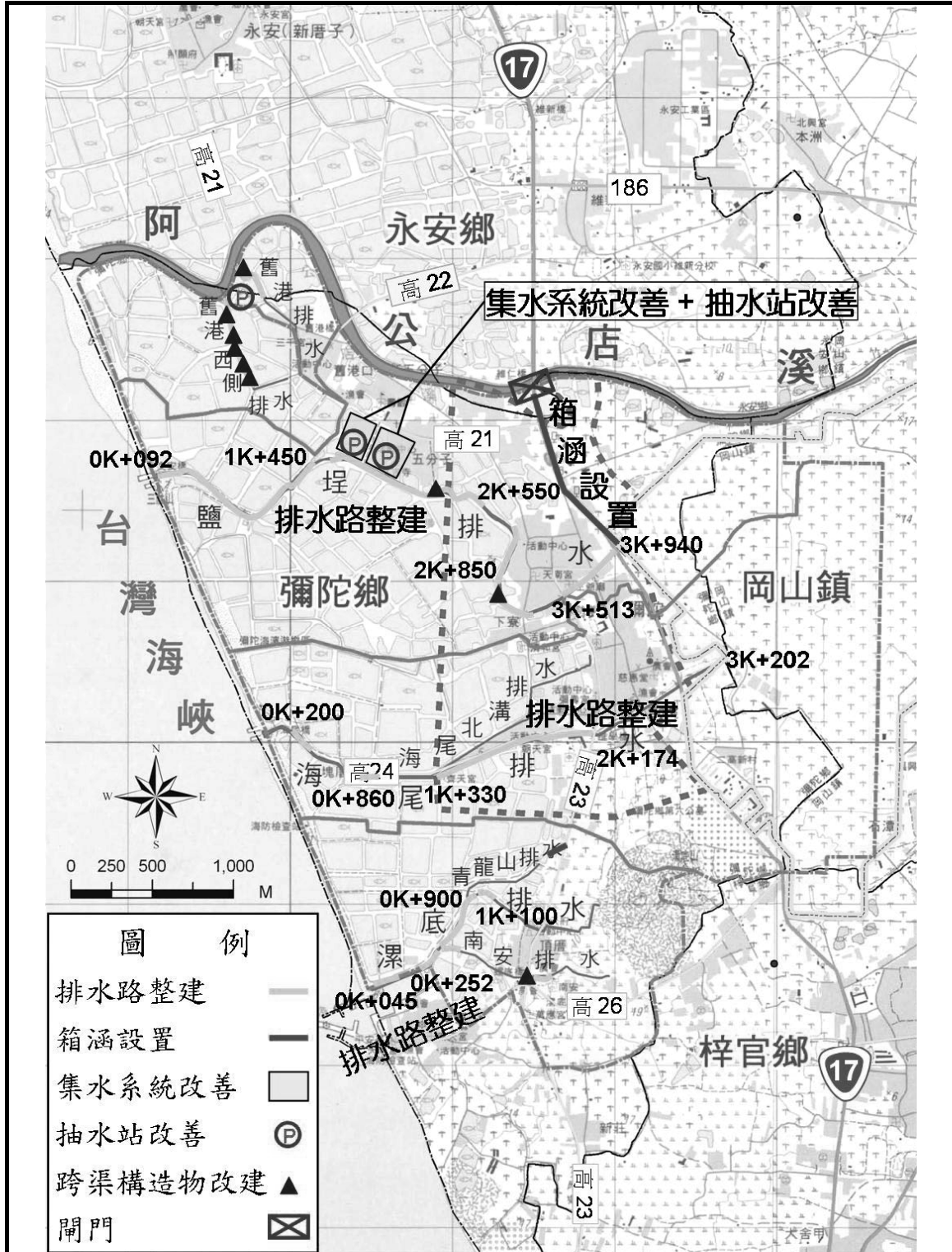
圖 2-6：彌陀地區排水系統改善工程佈置示意圖
